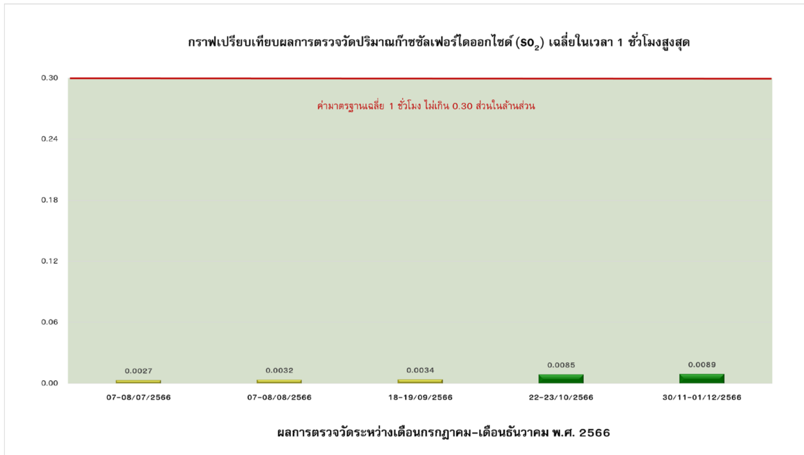
รูปภาพที่ 4-22 กราฟเปรียบเทียบผลการตรวจวัดปริมาณก๊าซซัลเฟอร์ไดออกไซด์ (SO 2 ) สูงสุด 1 ชั่วโมง บริเวณพื้นที่โครงการ (เดือนกรกฎาคม ถึงเดือนธันวาคม พ.ศ.2566)
