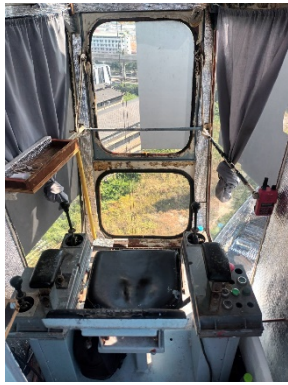
รูปที่ 73 ห้องขับเคลื่อนปิดมิดชิดและเบาะรองด้วยฟองน้ำ
