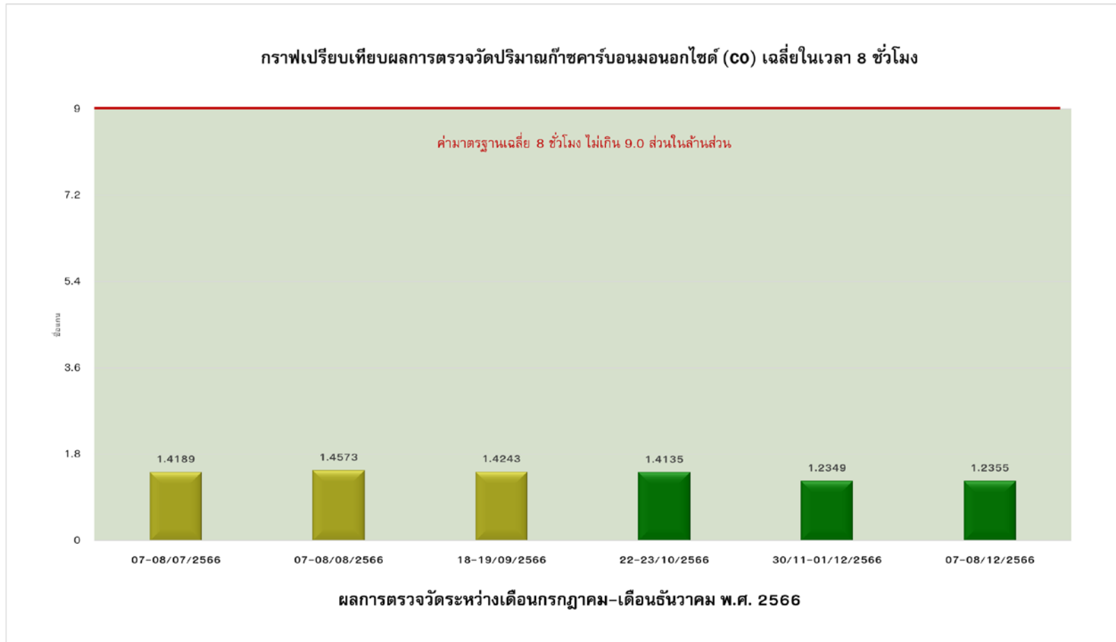
รูปภาพที่ 4-18 กราฟเปรียบเทียบผลการตรวจวัดปริมาณก๊าซคาร์บอนมอนอกไซด์ (Carbon monoxide; CO) เฉลี่ยในเวลา 8 ชั่วโมง บริเวณพื้นที่โครงการ (เดือนกรกฎาคม ถึงเดือนธันวาคม พ.ศ.2566)
