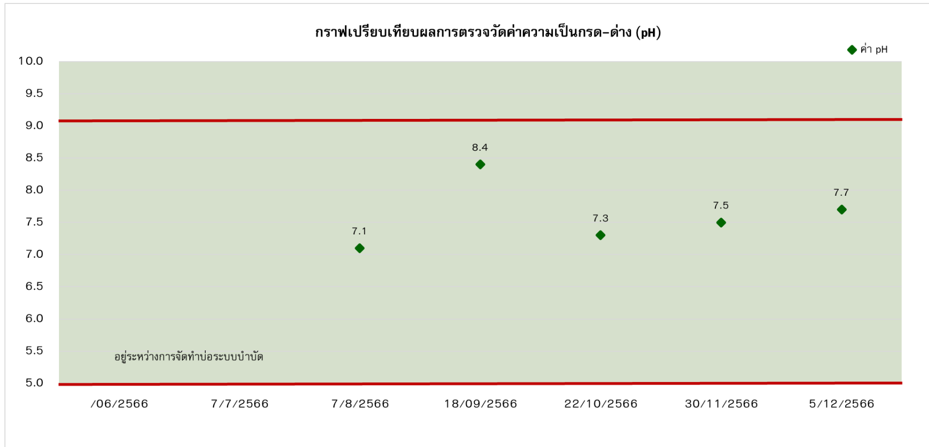
รูปที่ 4-45 กราฟเปรียบเทียบผลการตรวจวัดค่า pH บริเวณบ่อกักน้ำสุดท้ายก่อนระบายสู่ท่อระบายน้ำสาธารณะ
