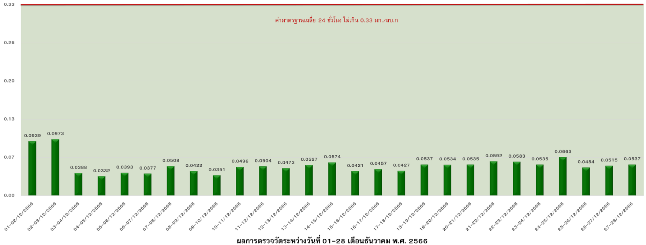
รูปภาพที่ 4-8 กราฟเปรียบเทียบผลการตรวจวัดปริมาณฝุ่นละอองรวม (TSP) บริเวณพื้นที่โครงการ (วันที่ 01 พฤศจิกายน ถึง 01 ธันวาคม พ.ศ.2566)
